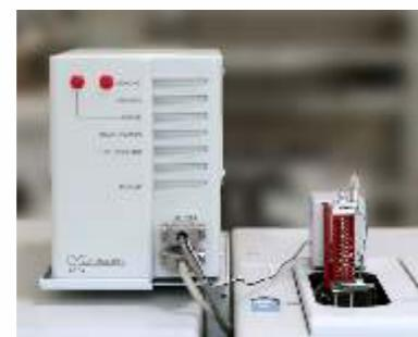
■ Дозатор твердых проб предназначен для анализа летучих компонентов твердых образцов пробы, например, при экспертизе давности документов
