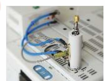
Установка сорбционной трубы в автоматическом и ручном исполнениях термодесорбера
