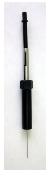
Рисунок 1 – Ручной шприц для ТФМЭ, покрытый пленкой 100 мкм полидиметилсилоксана(S
