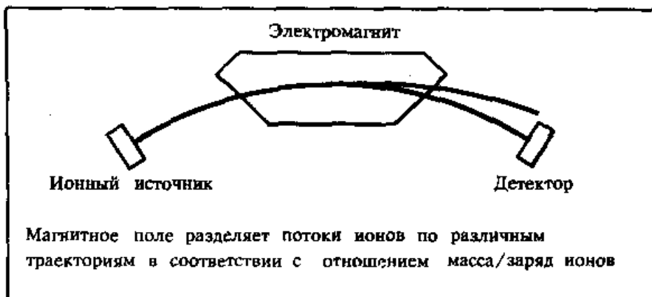
Рис.6. Принципиальная схема масс-спектрометра.
