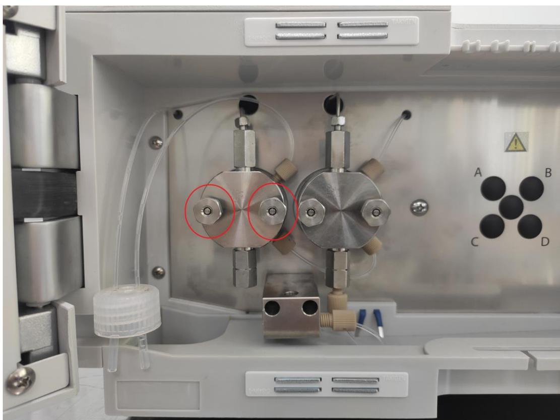
6. Извлеките головку насоса, потянув её на себя вдоль оси плунжера, чтобы не повредить плунжер.
