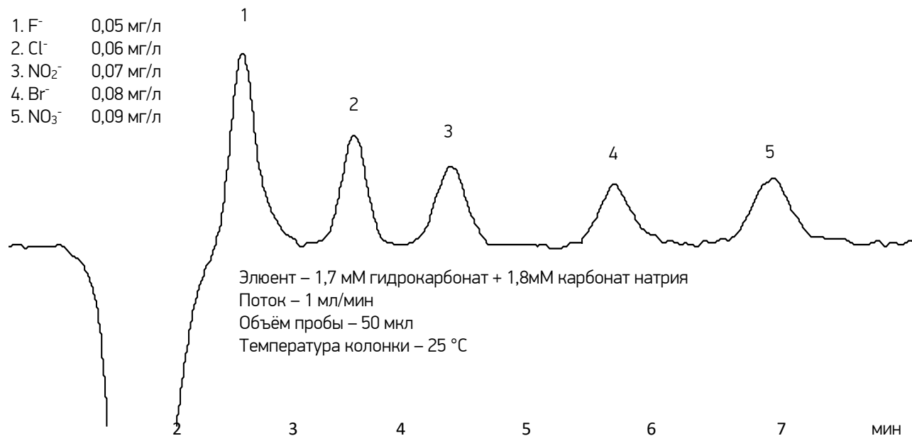
Рисунок 3 – Смесь анионов с малой концентрацией на колонке Phenomenex Star-Ion-300A
